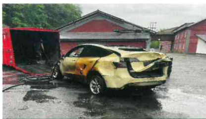
Für den Versuch wurde die Hochvolt-Batterie eines Tesla Model Y im Havariecontainer gezündet. Das Bild zeigt das Fahrzeug nach dem Brand.
